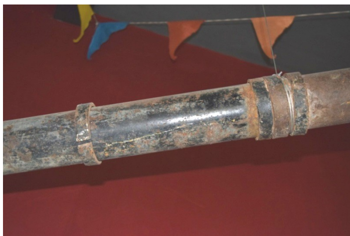
MUSEO DE LA RAMA, AGAETE. DETALLE DEL PRIMER Y SEGUNDO REFUERZO DE LA CULEBRINA CON SUS CUATRO ARANDELAS PARA EVITAR LOS REVENTONES. FOTO DEL AUTOR, 2022
